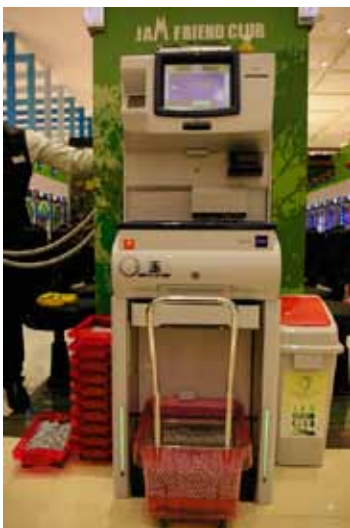
業界初の玉計数機。キャスターや脱着可能なハンドル(取手)の付いた玉箱は、持ち上げずに計数機にはめ込むだけ。スタッフの労務軽減に効果大
